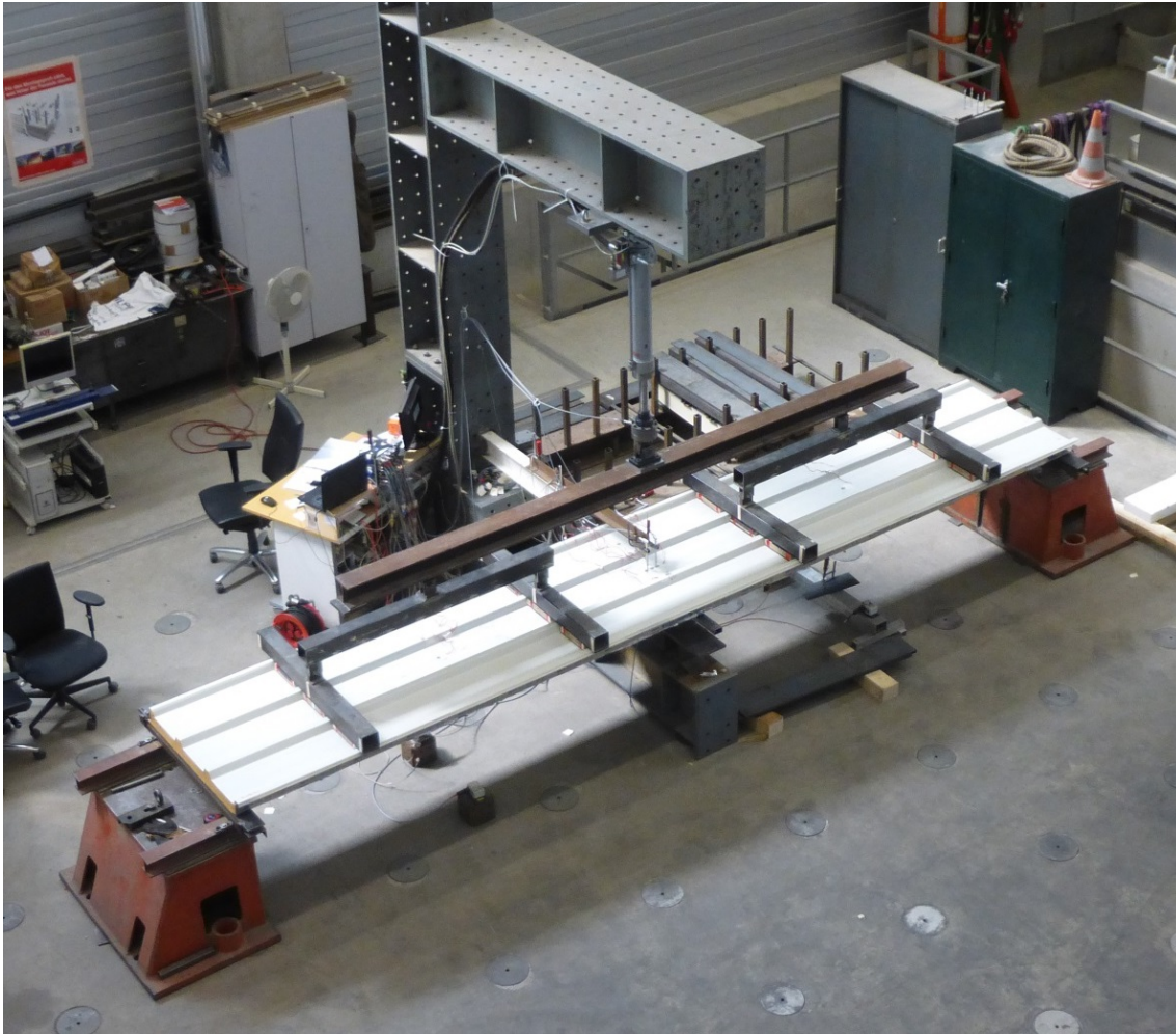
(a) Versuchsaufbau, Ausführung mit Dachelement.
