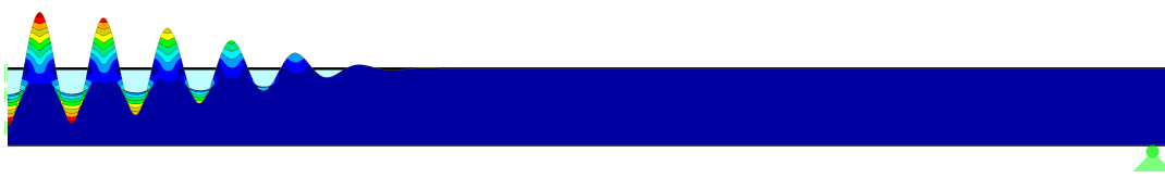
Abbildung 8.4: Erste Eigenform am Beispiel der linierten Deckschicht mit E_C = G_C = 3,5 \text{ N/mm}^2 für das Einfeldträgermodell. Symmetrieachse am linken Modellrand.
